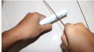
*Gambar 3 Proses Pematongan Pipa
