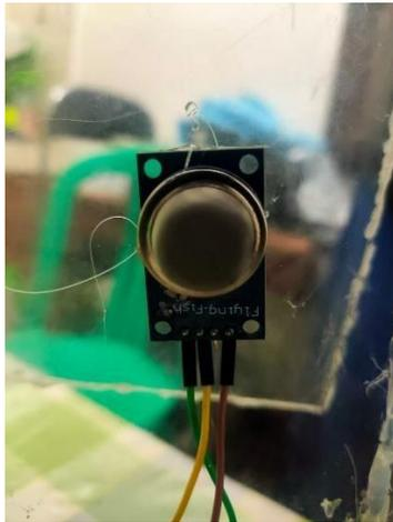
Fungsi Sensor MQ-6 pada Proyek Akhir ini ialah sebagai pendeteksi/pengukur yang digunakan untuk mendeteksi lpg dengan sensitivitas yang tinggi lalu mengkonversi suatu besaran menjadi satuan analog sehingga dapat di baca oleh rangkaian elektronik
