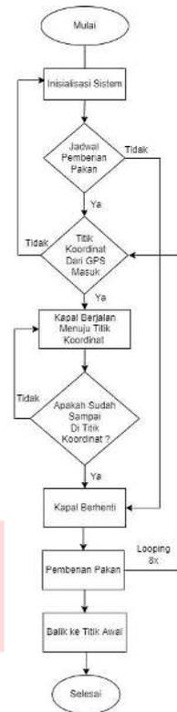
Gambar 3. 11 Flowchart Sistem Pergerakan kapal
