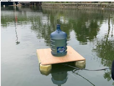
Gambar 4. 3 Pengujian Beban Maksimal Lambung Kapal
