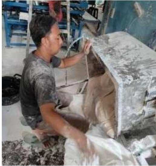
Gambar I. 3 Proses pengambilan adonan dari mesin pengaduk eksisting
