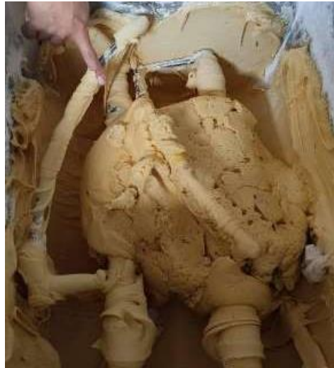
Gambar I. 2 Sisa adonan pada mesin setelah proses pengadukan eksisting
