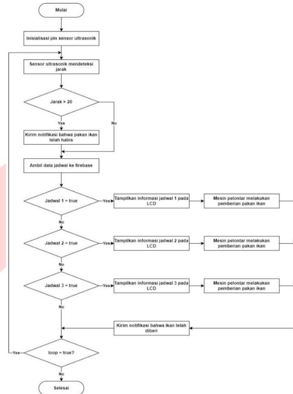
GAMBAR 2 DIAGRAM ALIR SISTEM PENDETEKSI KETERSEDIAAN PAKAN
