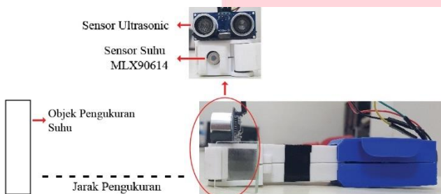
Gambar 7. Skenario Pengujian Menggunakan Modul Ultrasonik
