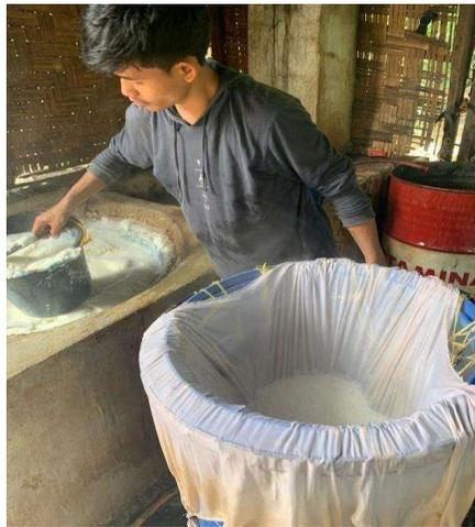
Gambar I.11 Pemindahan Bubur Kedelai dari Wajan ke Dalam Penyaringan
