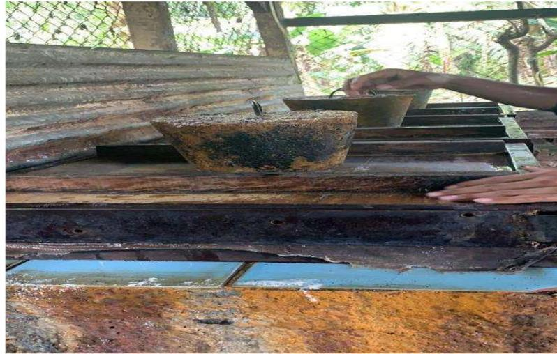
Gambar 1.8 Proses pengepresan dan pencetakan sari pati tahu kedelai di UMKM Ibu Lia
