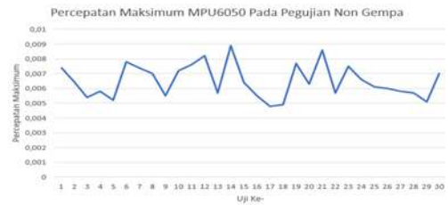
GAMBAR 14 Percepatan Maksimum Pada Pengujian Non Gempa
