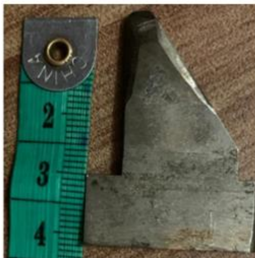
Gambar 1. 3 Kondisi dudukan pencekam eksisting (Sumber : Penelitian Pratama, 2021)
