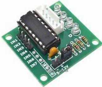
GAMBAR 6 Motor Driver ULN2003
