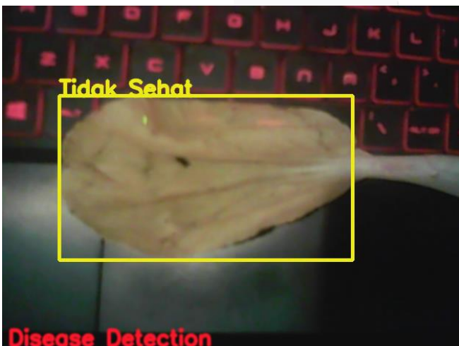
GAMBAR 11 Kamera mendeteksi kondisi tanaman sawi hijau tidak sehat
