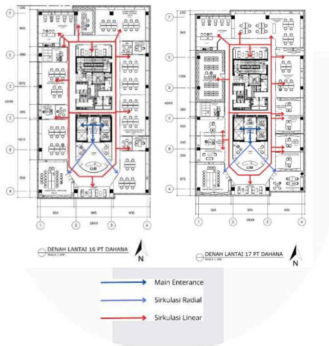
Gambar 6. Kebutuhan Blocking Lantai 16 dan 17 Perancangan Kantor Marketing danOperasional PT Dahana Sumber: Penulis, 2023
