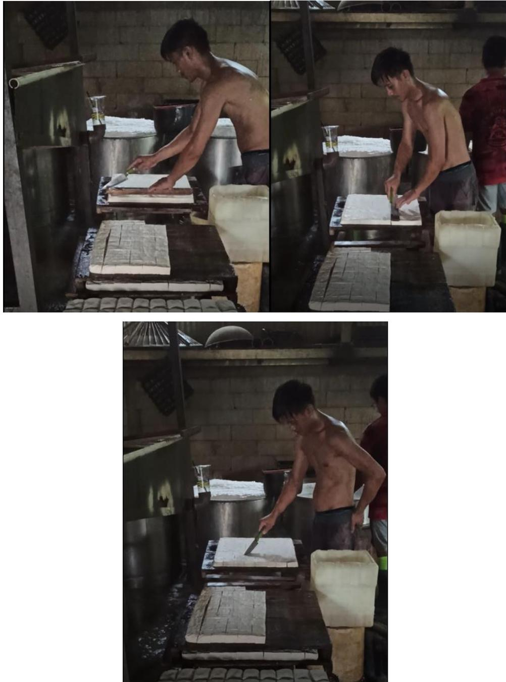
Gambar 1. 4 Pemotongan tahu secara vertical, horizontal dan diagonal
