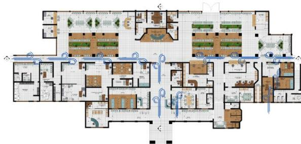
Gambar 11 Konsep penghawaan alami area rawat jalan
