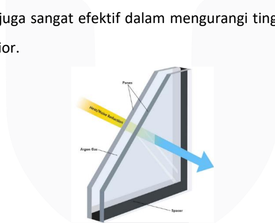
Gambar 9 Penerapan Double Glazing Sumber: dokumentasi penulis
