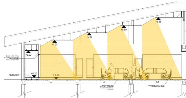
Gambar 2 ceiling akustik dengan hukum snellius pada ruang bermain VR dan PC Sumber: dokumentasi penulis
