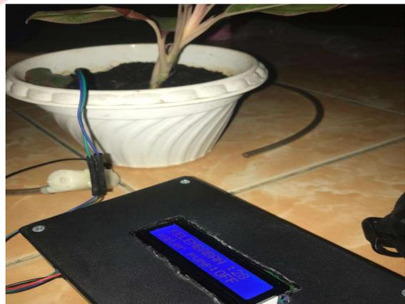
Analisa untuk pengujian sensor kelembaban tanah pada tanah biasa menggunakan blynk pada jaringan yang sama dan jaringan yang berbeda. Hasil yang diperoleh dari pengujian tersebut adalah sensor kelembaban dapat mendeteksi kelembaban tanah dengan benar. Hasil yang diperoleh sangat baik sesuai dengan perancangan alat.
