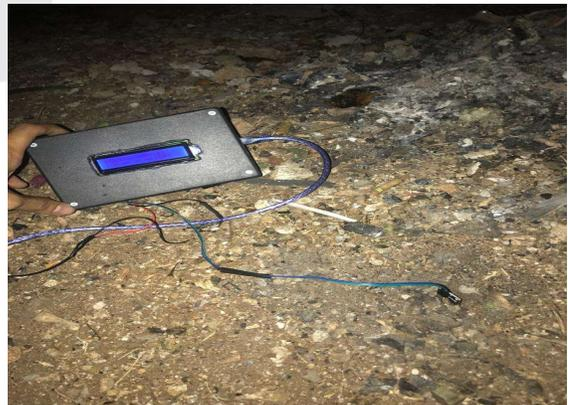
Analisa untuk pengujian sensor kelembaban tanah pada tanah berbatu menggunakan blynk pada jaringan yang sama
