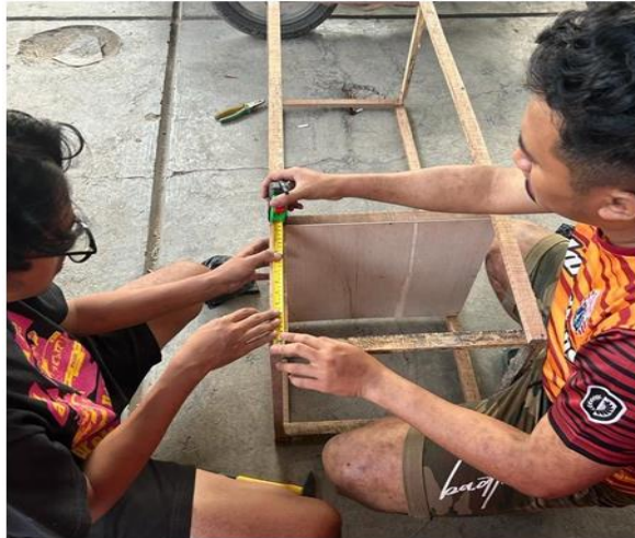
Gambar 21 Proses pembuatan rangka pedestal Sumber: Pribadi (2023)
