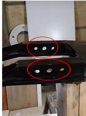
Gambar 5 Penambahan lubang atau rongga pada titik-titik tertentu pada rangka Sumber: Dokumen Pribadi
