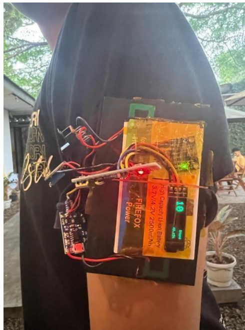
Gambar 4. 12 Pengujian Sistem Monitoring Alat Penghitung Langkah Kaki
