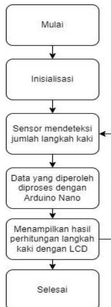
Gambar 4. 5 Diagram Alir Sensor Pendeteksi
