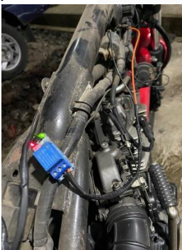
GAMBAR 4.1 Relay Kondisi Mati
