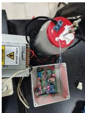
GAMBAR 3. 2 Implementasi Sistem pada Generator HHO
