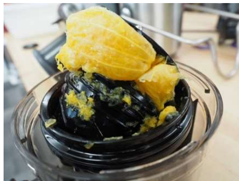
Gambar 1.1 Irisan jeruk utuh tersangkut di auger Hurom H-AA, dan menolak untuk didorong ke bawah.
