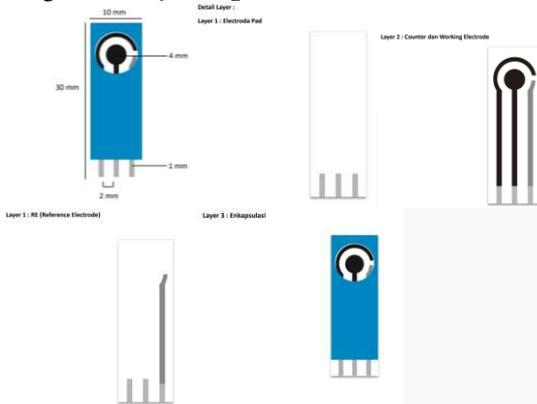
GAMBAR 3. 2. Desain Screen Printed Electrode siap cetak
