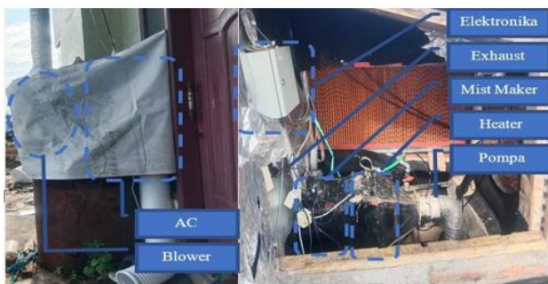
Gambar 4. 1 Realisasi Sistem Kontrol Suhu dan Kelembaban beserta Aktuator
