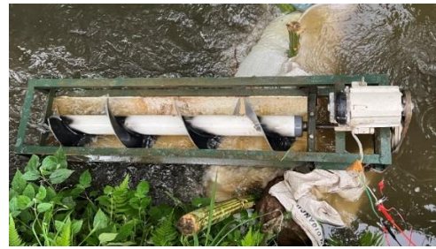
GAMBAR 3. Pengujian Turbin dan Generator
