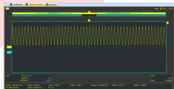
GAMBAR 7 Pengujian 1000 Hz pada tampilan Osiloskop
