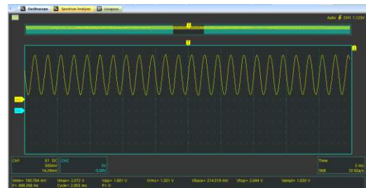
GAMBAR 6 Pengujian 500 Hz pada tampilan Osiloskop
