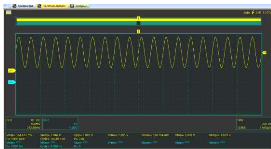
GAMBAR 9 Penguian 10 KHz pada tampilan Osiloskop
