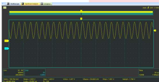
GAMBAR 10 Penguian 50 KHz pada tampilan Osiloskop
