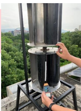
Gambar 3.3 Pengujian Turbin menggunakan Tachometer di TULT
