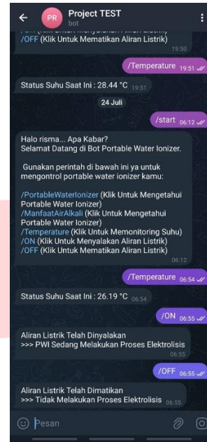
GAMBAR 7. Command Untuk Mengontrol PWI
