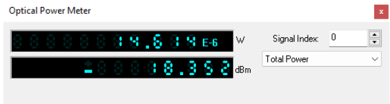
GAMBAR 5. Hasil simulasi LPB downlink terdekat
