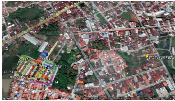
GAMBAR 3. Jalur perancangan FTTH
