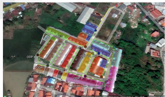
GAMBAR 2. Jalur perancangan FTTH
