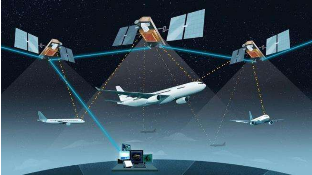
Gambar 1.1 Arsitektur Sistem ADS-B Berbasis Satelit
