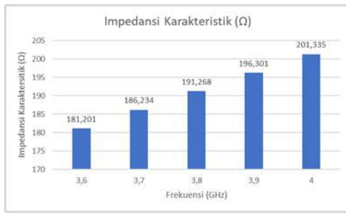
GAMBAR 4.12 Impedansi Karakteristik berdasarkan Frekuensi
