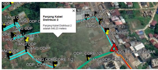
GAMBAR 5. Panjang Kabel Distribusi 2
