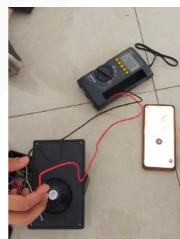
GAMBAR 4 Pengukuran Frekuensi Output dengan Multimeter
