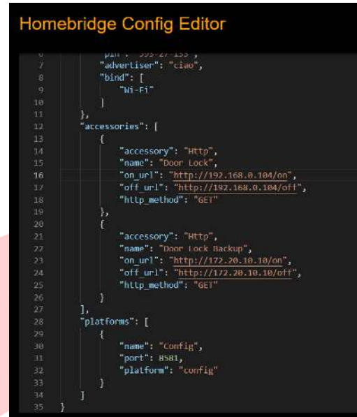
Gambar 5. Tangkapan layar konfigurasi Homebridge
