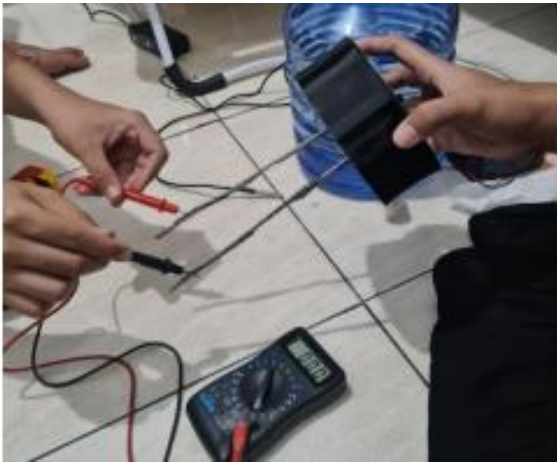
GAMBAR 10. Pengukuran Volt Pada Elektroda (LED Off)
