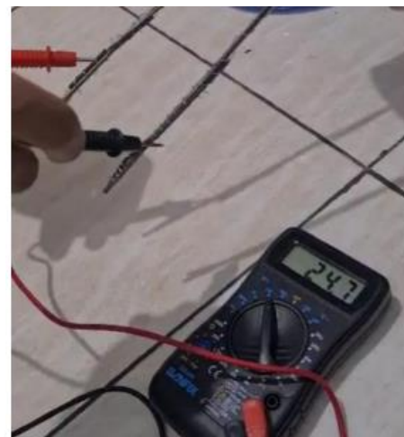
GAMBAR 9. Pengukuran Volt Pada Elektroda (LED On)
