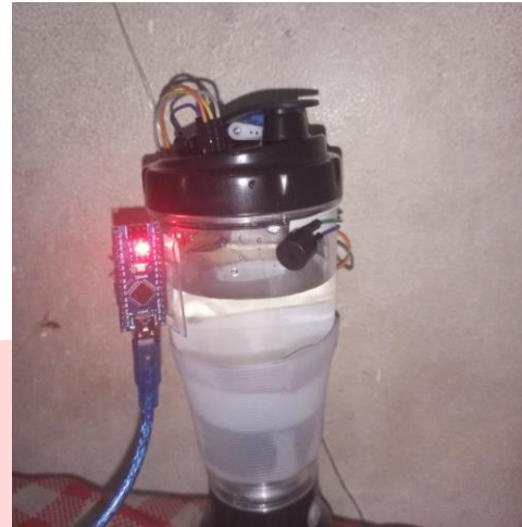
Gambar 8 (Realisasi Perangkat Motor Servo dan Buzzer yang Sudah Terisi Air Penuh)
