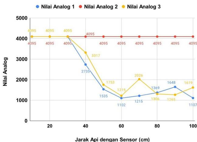
Gambar 3. Grafik Pengujian Sensor IR Flame dengan Jarak Api
