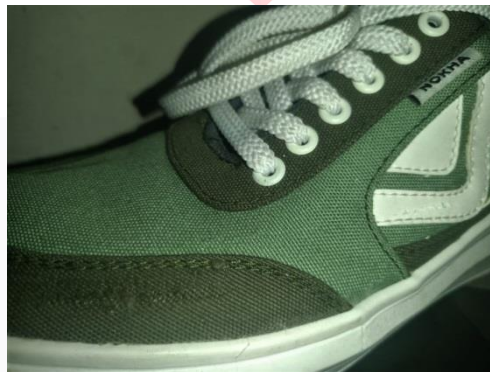
Gambar 12 Sobekan Akibat Gesekan Sumber : Penulis 2023
