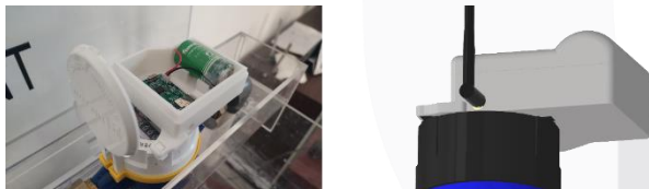
GAMBAR 10 PENYESUAIAN PENGUNCI METER AIR
