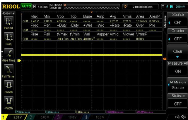
Gambar 4.2 Hasil pengujian Three Phase Rectifier dengan kapasitor
