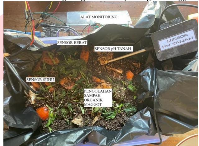
Gambar 9. Pemasangan Alat Monitoring
