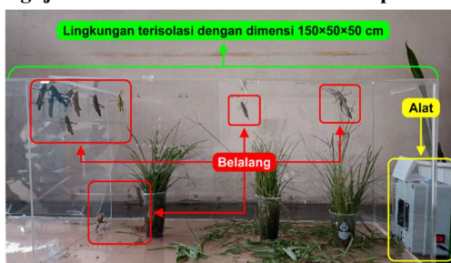
Gambar 6.3 Pengujian Frekuensi Multivibrator Astabil terhadap Belalang
