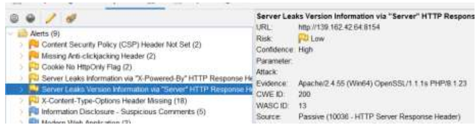
Gambar IV.21 Hasil Scan Zap pada server dummy
