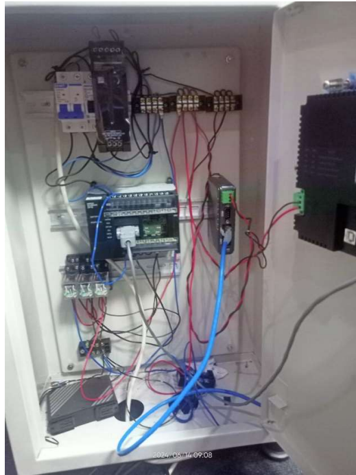
Gambar rangkaian PLC.
