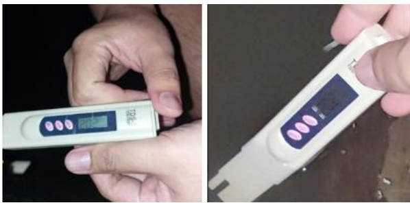
GAMBAR 20. Pengukuran nilai TDS (ppm) menggunakan TDS Meter-3
