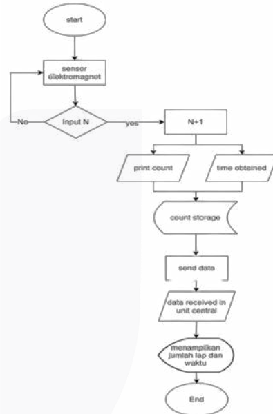
GAMBAR 8 Flowchart Pengolahan Data Sistem
