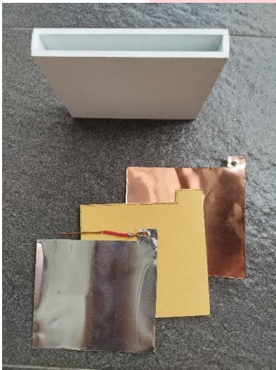
GAMBAR 18: HASIL AKHIR INTEGRASI MODUL BATERAI ALUMINIUM
