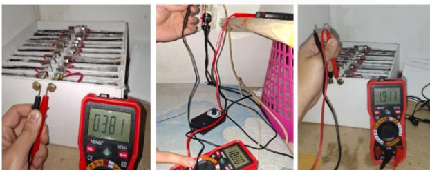
GAMBAR 23: HASIL PENGUJIAN PENGISIAN MODUL BATERAI ALUMINIUM
