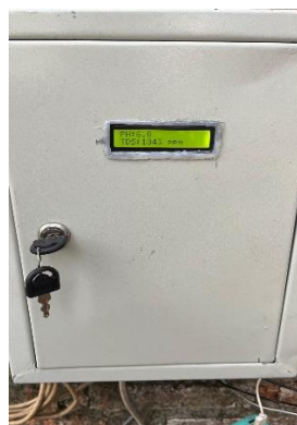
GAMBAR 11 Tampilan LCD untuk Sensor pH
