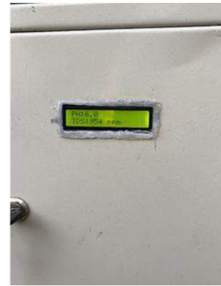
GAMBAR 13 Tampilan LCD untuk sensor TDS
