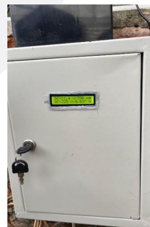
GAMBAR 15 Tampilan LCD untuk Sensor PZEM-004T
