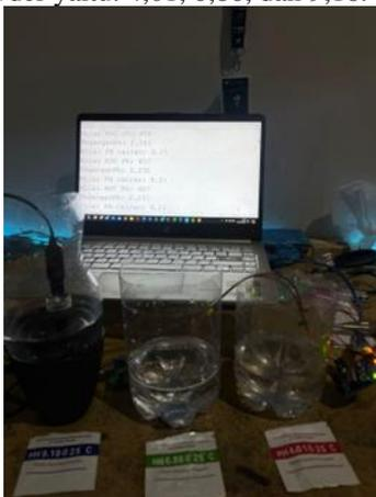
GAMBAR 5 Kalibrasi Dengan 3 jenis pH Buffer Powder
